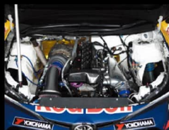
今回、過渡特性やレスポンスを改善するため、ドラッグマシンのごとくNOS（亜酸化窒素）をエンジン内に噴射。最大1600馬力までパワーを上げた。しかしロバンペラの反応はいたって平静だったという。
